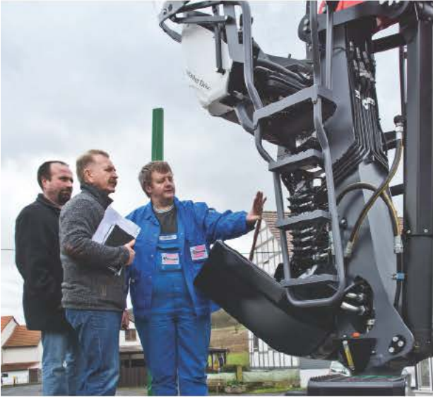
Klaus Röttger zeigt Arnd-Wilhelm Pasch und Christian Kriep (v.r.n.l.) die Hydraulikversorgung, die dank Drehverteiler im Kranfuß und GFK-Abdeckung im Betrieb fast unsichtbar wird.
